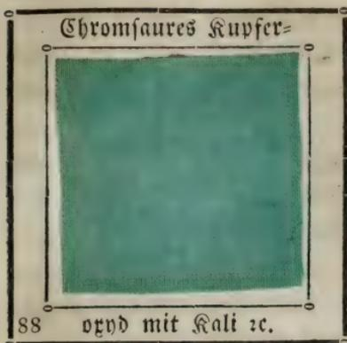
Kali- und Natronlauge so wie Kalkwasser verwandeln das Braun in Blau. Sie zersetzen nämlich das chromsaure Kupferoxyd, indem sie ihm die Chromsäure entziehen und das Kupferoxyd im Zustande des blauen Kupferoxydhydrats zurück lassen.
